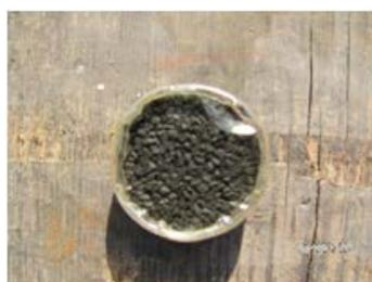
Рисунок 7 – Дополнительный воспламенитель из дымного пороха, размещенный в ампуле из нитроосновы
